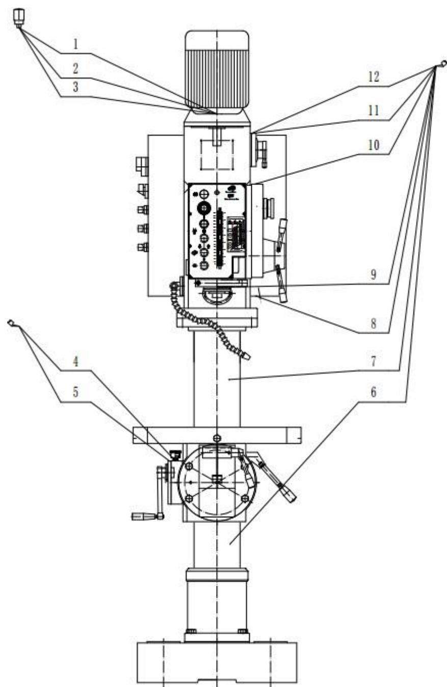
**Рис. (6) Схема смазки**
